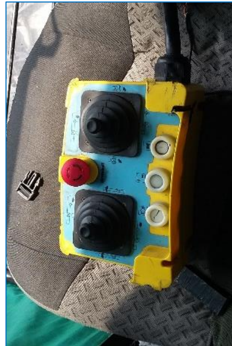
Figura 5.14. Control de operación de la grúa torre. Fuente: Arq. Michel Tomé Toriz.
