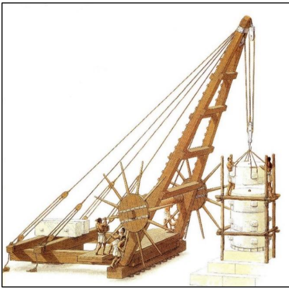
Figura 2.2. Grúa romana. Fuente: www.gruasyequiposgarcia.com
