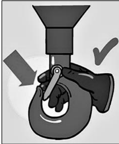
Figura 4.6.1.4. Verificación del pestillo de seguridad.
