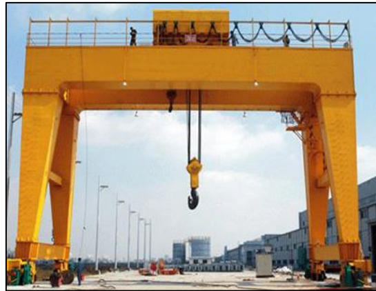
Figura 3.6. Grúa pórtico. Fuente: www.crane-lifting.com
