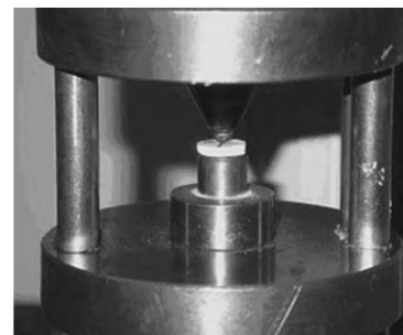
Figura 29. Prueba de resistencia a la flexión biaxial.
