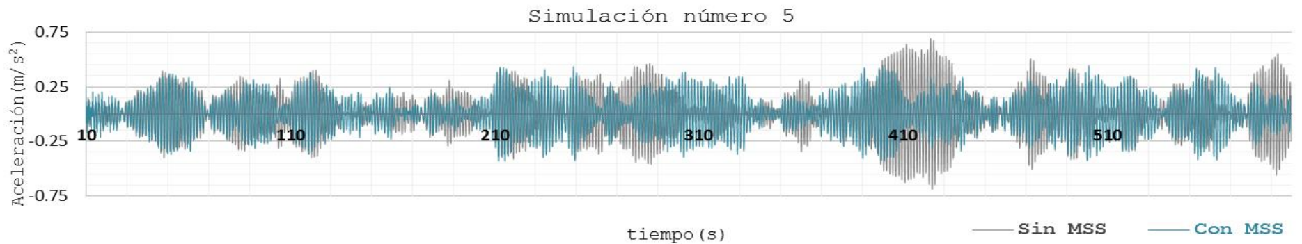
Figura 25. Historia en el tiempo de la aceleración en el nodo 392, debida a la quinta simulación.
