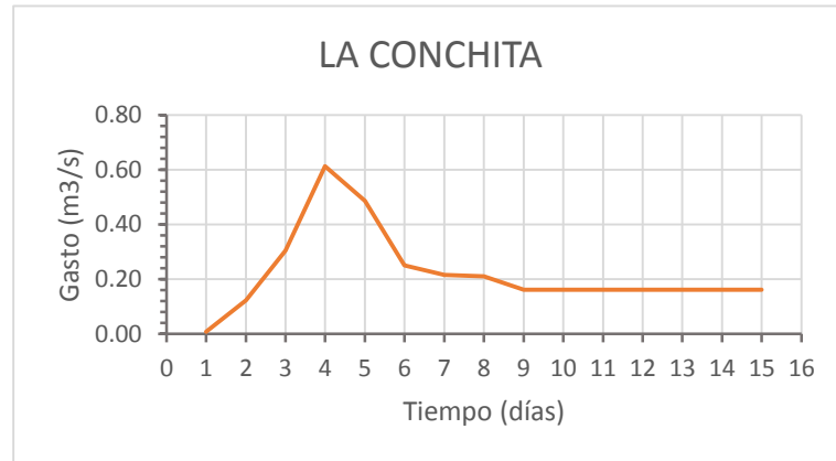
Gráfica 33. Hidrograma estación La conchita . Fuente: Elaboración propia con información del BANDAS
