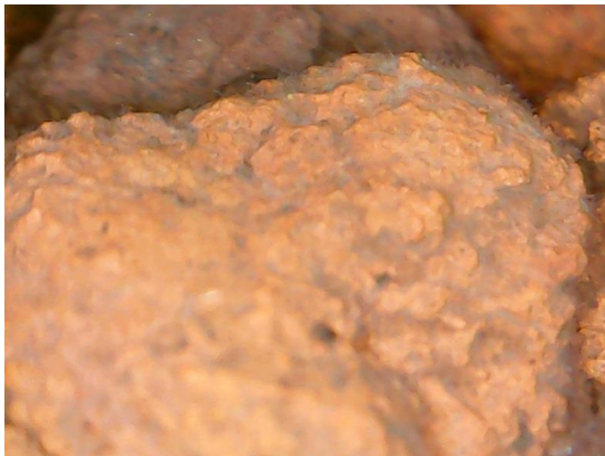
Figura 7.3 Biopelícula formada sobre la superficie del tezontle.
