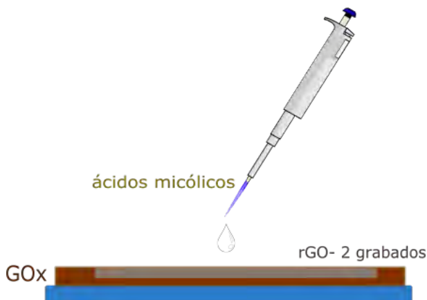
Figura 6.4: Deposito por Dropcasting de ácidos micólicos sobre la superficie de rG-pasta/dispersión con 2 grabados..
