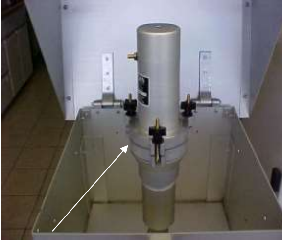
Figura 2.6A: Insección del módulo calibrador G40 en la boquilla del filtro. Debe asegurarse que este apretado y no debe existir fugas.
