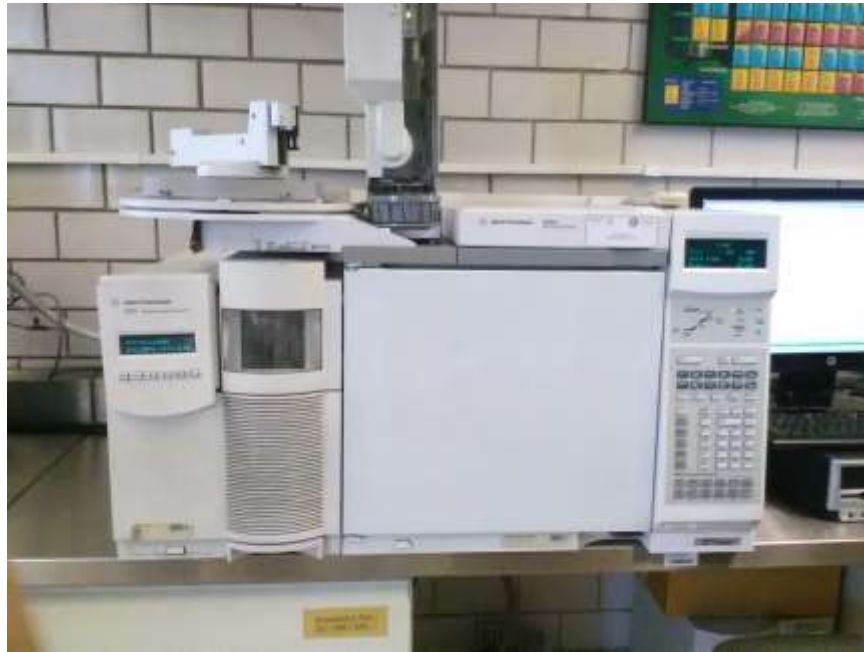
Figura 3.1: Sistema GC/MS: Cromatógrafo de gases Agilent 6890N y Detector Selectivo de Masas Serie Agilent 5975. Ubicado en las instalaciones de los Laboratorios INECC, CDMX.
