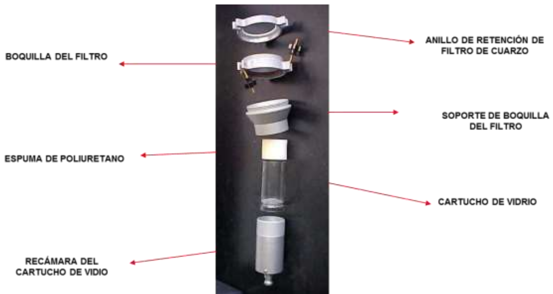
Figura 2.5: Módulo de muestreo dual para el TSP High Volume Air Sampler Tisch Environmental®, modelo TE-100 PUF. El PUF se inserta directamente el cartucho de vidrio para la captura de los COPs estudiados en este trabajo.
