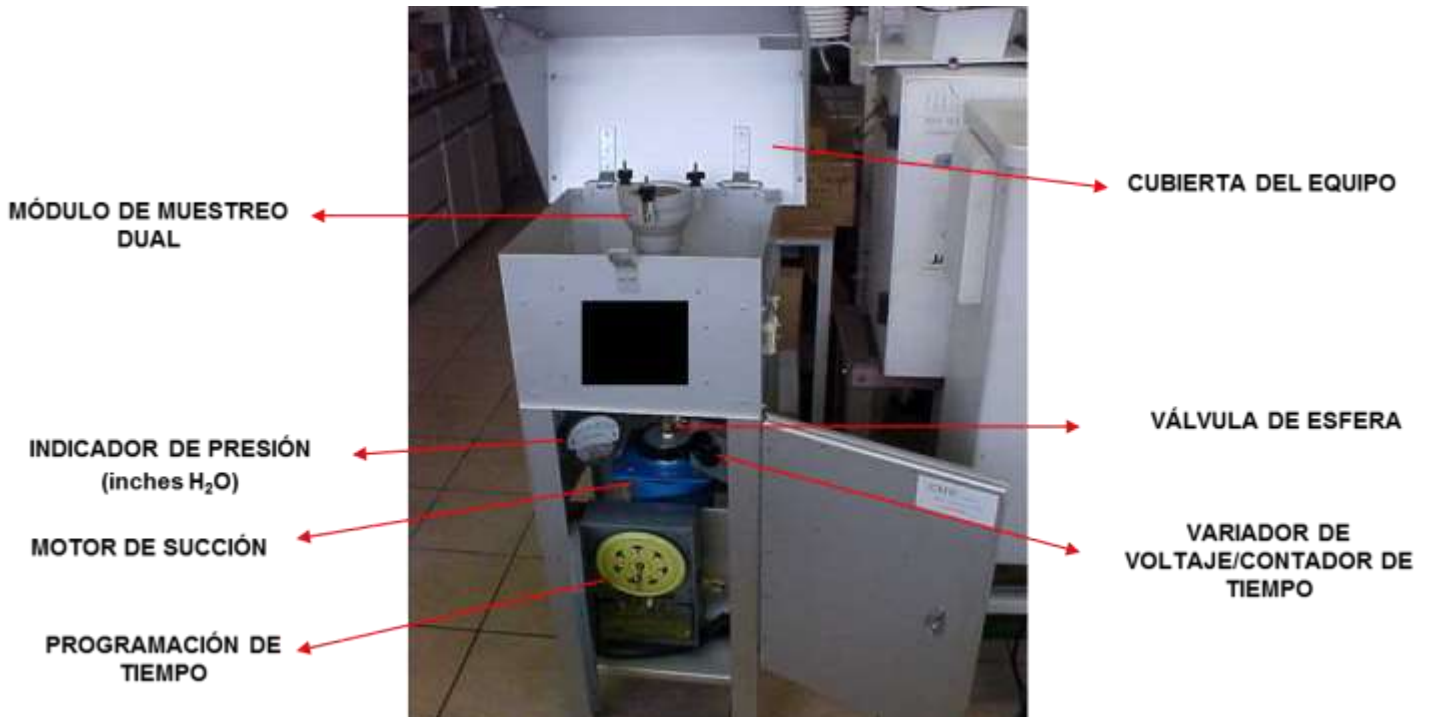
Figura 2.4: TSP High Volume Air Sampler Tisch Environmental®, modelo TE-100 PUF; Utilizado para la recolección de las muestras durante los períodos de muestreos comprendidos en el período de mayo 2016.
