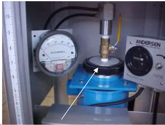
Figura 2.8A: Válvula abierta y manómetro en "U".
