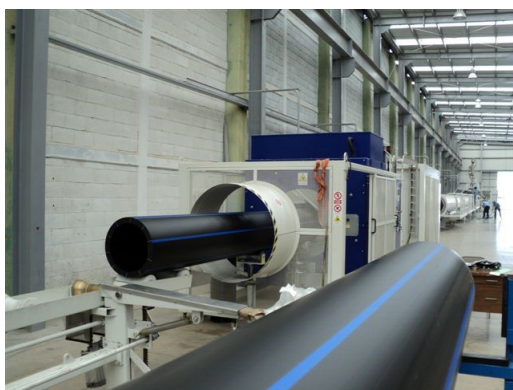
Figura 1.2: Proceso de fabricación de tubos de PEAD (Recuperado de [1]).
