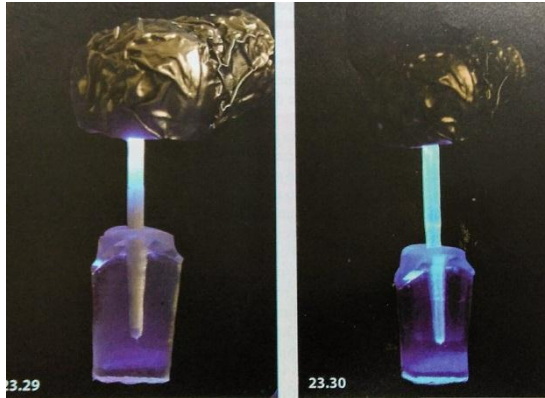
Fig.10 Diferencia de trasmisión de luz en dos postes de fibra de vidrio. 16
