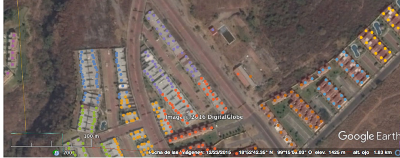
Figura 3-4: Microrredes formadas con el algoritmo k -means con n=36 , nodos pertenecientes a una misma microrred tienen el mismo color. Datos del mapa: Google, DigitalGlobe.
