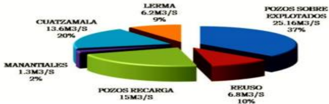
Figura 15 suministros de agua potable.
