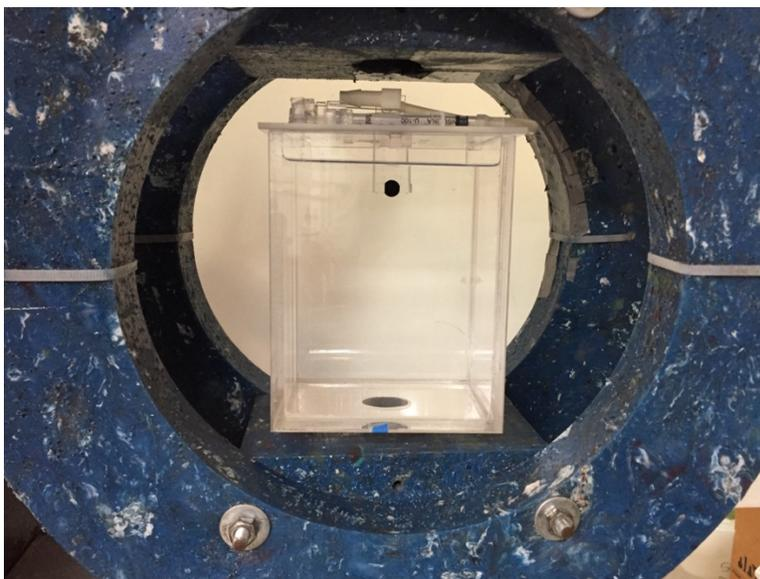
Figura 3.7. Contenedor con el fluido y el mecanismo de liberación de esferas montados en el centro de la bobina.
