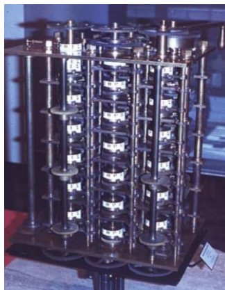
Figura 1 Máquina diferencial de Charles Babbage 2
