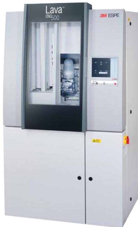
Figura 33 Equipo de fresado de restauraciones dentales Lava™ CNC 500. 43
