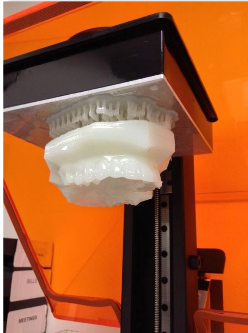
Figura 26 Modelo dental fabricado por inyección de polímero. 35
