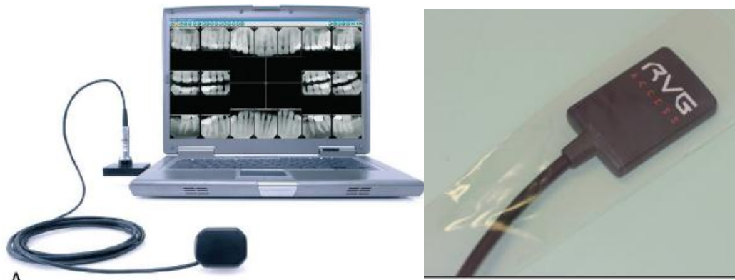
Figura 9 A, Componentes esenciales para la imagen digital directa. B, Sensor intraoral con cable óptico 6 .
