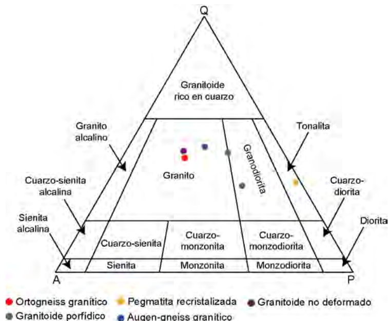
Figura 21. Diagrama de Streckeisen para rocas graníticas con los resultados del conteo modal de qz-pl-fs.
