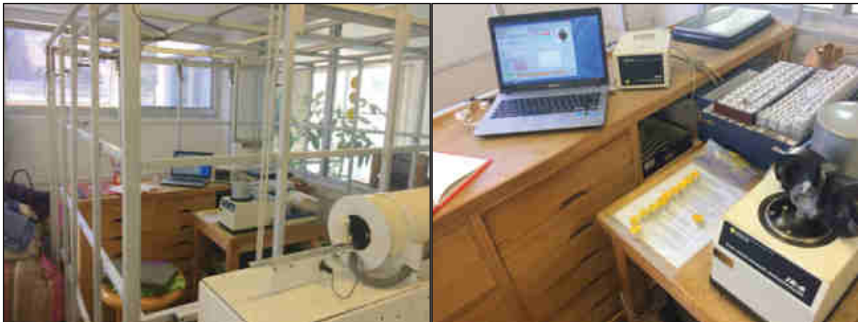
Imágenes 146 y 147. Izquierda: Magnetómetro al interior de la jaula libre de campo magnético y Desmagnetizador de Campos Alternos al exterior; derecha: magnetómetro de giro JR-6, muestras del proyecto y equipo con el software de medición. Fotos LSSM
