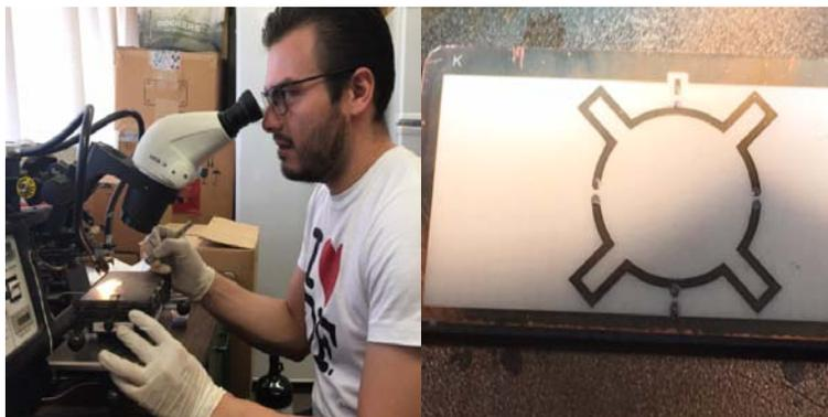
Figura 4.1.2.4.2 Colocación de la soldadura en pasta.
