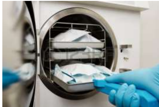
Fig. 19 Método de esterilización calor en seco se utiliza para la eliminación de los microorganismos creado reacciones de oxidación y medio interno árido para estas. 33
