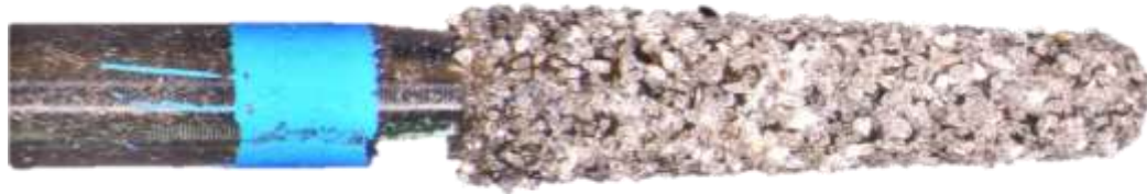
Fig. 15 Macrofotografía que muestra cómo se compone una fresa de diamante y como se encuentra unido el polvo de diamante industrial a la punta activa. 16
