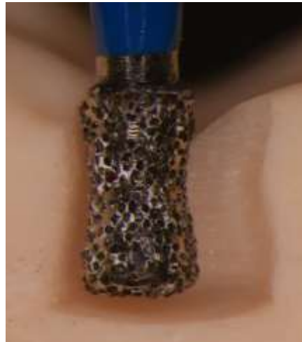
Fig. 26 Desgaste producido por una fresa de doble cono invertido. 34
