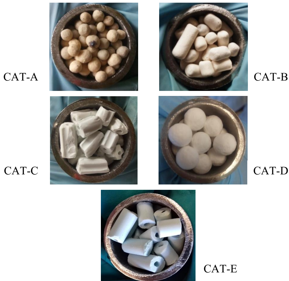
Figura 2.1 Fotografías de los cinco soportes de catalizador utilizados en las pruebas experimentales para medir caída de presión. Las imágenes corresponden a los materiales empacados en el tubo de proceso, este último con dimensiones 2.0 m, 1 pulg de OD ced 14 y 2.119 cm de diámetro interno.
