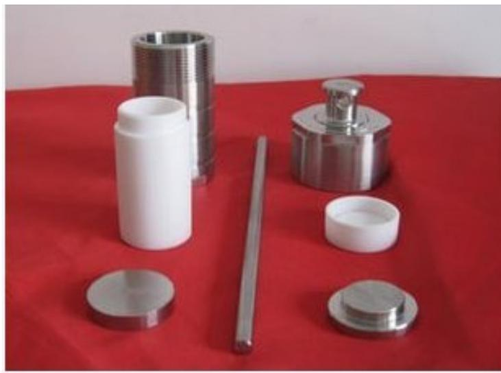
Figura 3.5: Autoclave y Reactor para síntesis hidrotermal y solvotermal.
