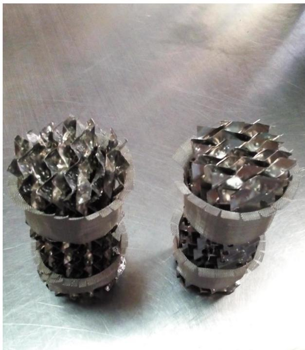
**Figura 10.** Empaques estructurados construidos
