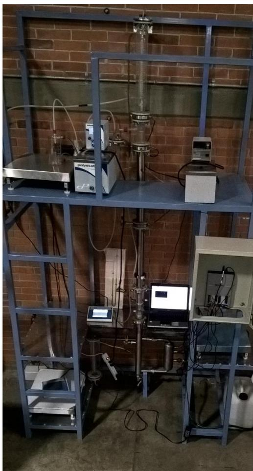
**Figura 11.** Columna de destilación reactiva instalada en la Nave-1000
