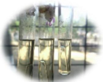
Figura 37 Muestra en tubos con caldo lauril sulfato. Ausencia de gas o crecimiento microbiano.
