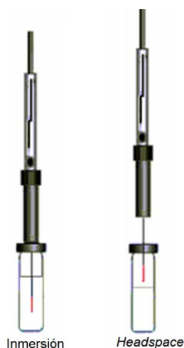
Figura 2.4.2.2 Formas de trabajo con SPME: inmersión y headspace.
