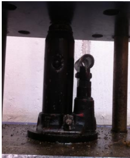
Figura 3.5.- Gato hidráulico en mal estado.
