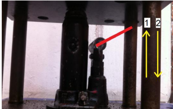
Figura 5.7. La carga se aplica en dos movimientos, levantando la palanca y regresándola a su posición original.
