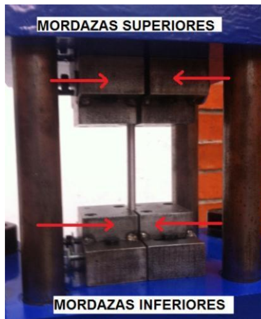
Figura 4.12. Fuerzas aplicadas sobre la probeta.
