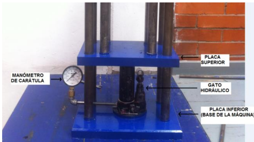
Figura 4.3.- Componentes de la estructura inferior.
