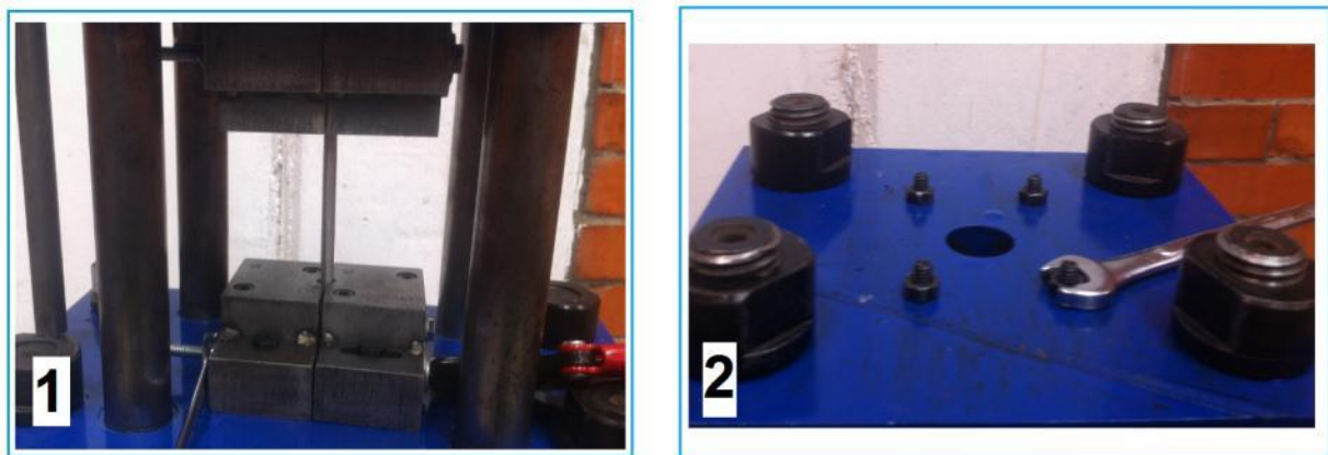
Figura 6. Primero apretar tornillos horizontales y después los verticales.
