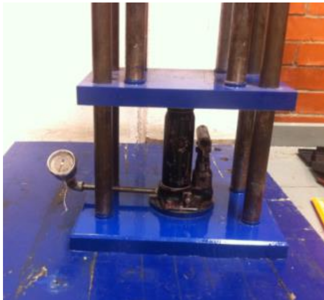
Figura 4.4.- Gato hidráulico con conexión para manómetro.
