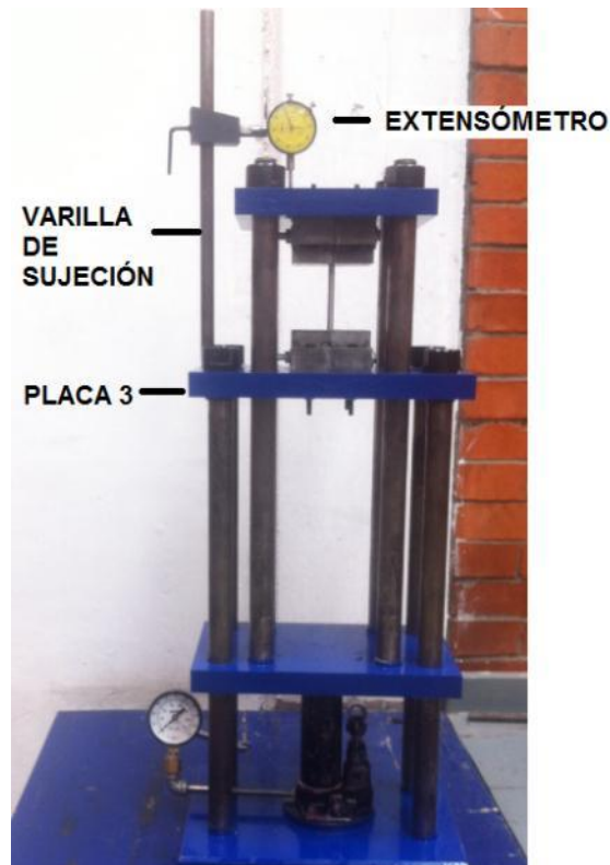
Figura 4.9. Varilla de sujeción del extensómetro sobre la placa 3.
