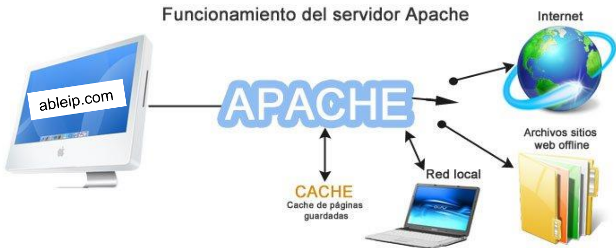
Fig. 5.1 Funcionamiento del servidor Apache.
