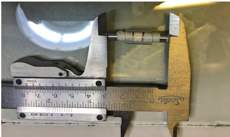
Figura 14. Imagen donde se muestran las membranas enrolladas dentro del porta muestras de vidrio, para la medición en la dirección uno.
