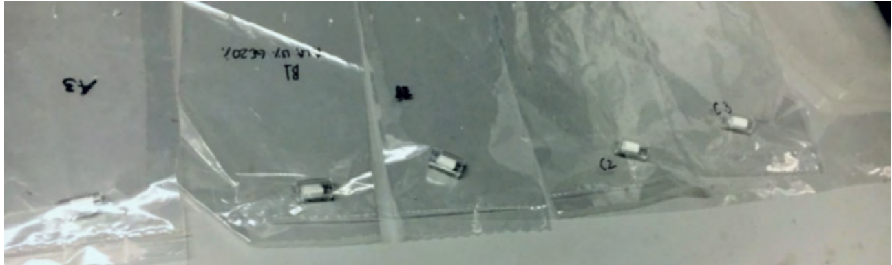
Figura 14. Imagen donde se muestran las membranas enrolladas dentro del porta muestras de vidrio, para la medición en la dirección uno.
