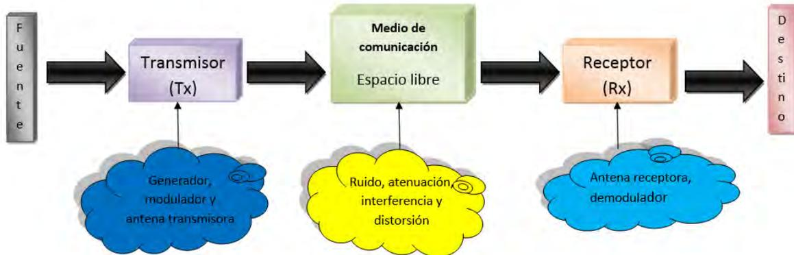
Figura 1.1: Esquema simplificado de un sistema de radiocomunicaciones .
