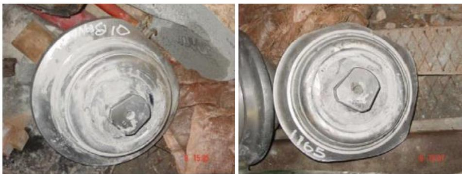
Figura 3.4 Desgaste anormal de los discos de corte (plano y multiplano). (Zhao et al., 2007)
