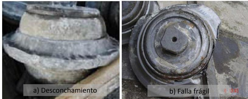
Figura 2.10 Tipos de falla en discos de corte. (Zhao et al., 2007)
