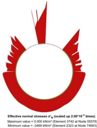
Figura 3.32 Esfuerzos normales de contacto sobre el escudo después de excavadas las galerías.
