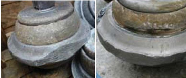
Figura 2.9 Desgaste plano y multiplano en discos de corte. (Hongsu et al., 2007)
