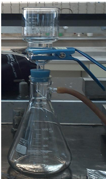
Figura 5.5. Equipo de filtración.
