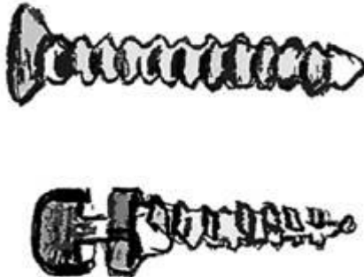
Figura 44. Colocación por autoperforación.
