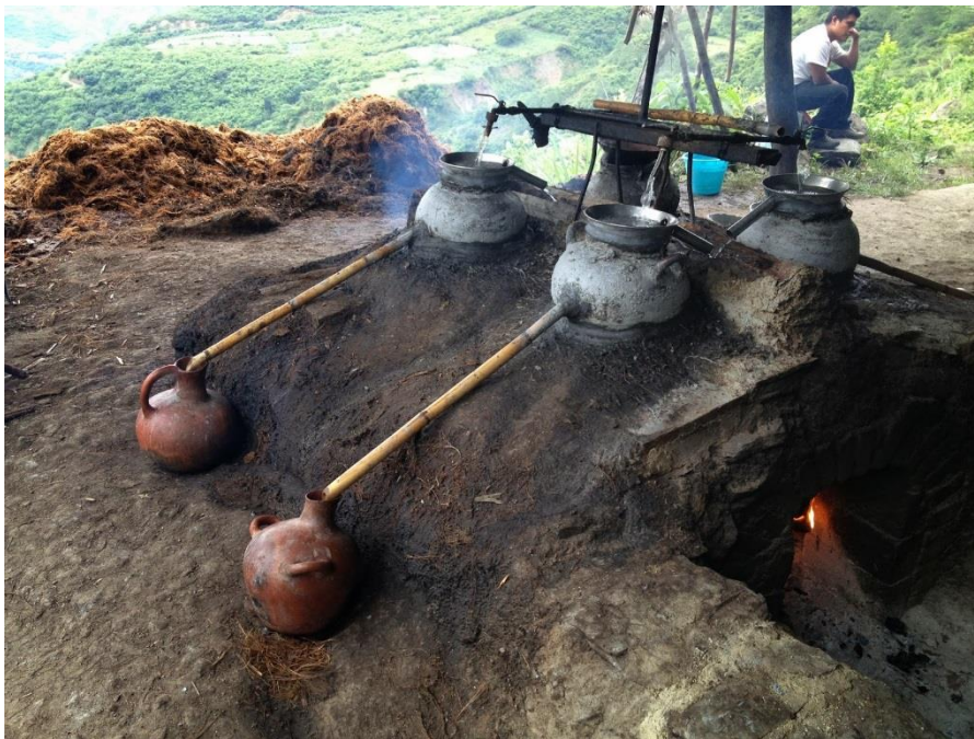
Imagen 5. Alambique de barro utilizado para destilar (En: Huerta, 2017)
