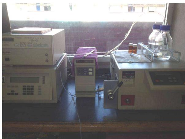
Fig. 3.4. Equipo de HPLC utilizado para la cuantificación del metam de sodio
