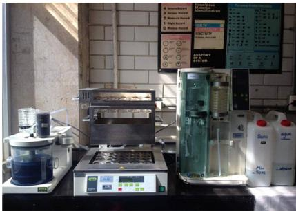
**Fig. 4.11. Determinación de proteínas por método de Kjeldahl**
