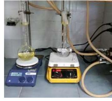
**Fig. 4.10. Determinación de grasa, se observan dos equipos Soxhlet con la muestra en digestión**
