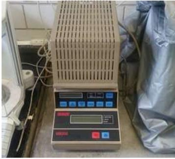
**Fig. 4.8. Determinación de humedad por termobalanza**
