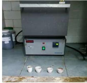
**Fig. 4.9. Determinación de cenizas, se observan los crisoles con las muestras en la campana**
