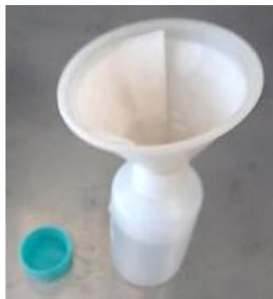
Figura 3.7 Filtración para la obtención de solución madre.
