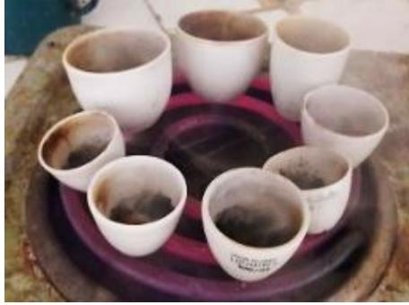
Figura 3.5 Calcificación de la muestra de alimento por la vía seca en parrilla con resistencia eléctrica.
