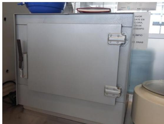
Figura 3.4 (A) Deseccación de muestras a 100°C por 24 horas. (B) Estufa de secado por convección para la obtención de materia seca.
