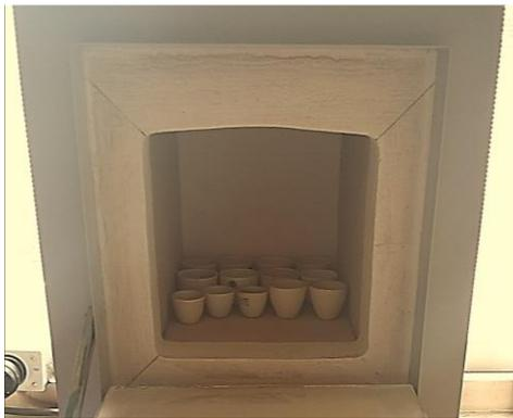
Figura 3.6 Incineración de muestras de alimento a 500°C por 24 horas, en mufla.
