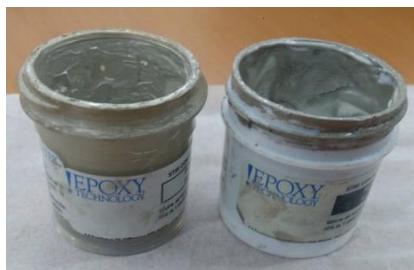
Figura 3. 17 Pasta epóxica de plata. Endurecedor con polvo de plata (izquierda); Pasta epóxica con polvo de plata (derecha).
