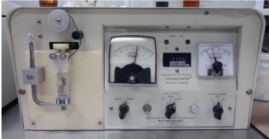
Figura 34. Equipo CHLORDOMETER utilizado en el área de pruebas especiales para la determinación de electrolitos en sudor
