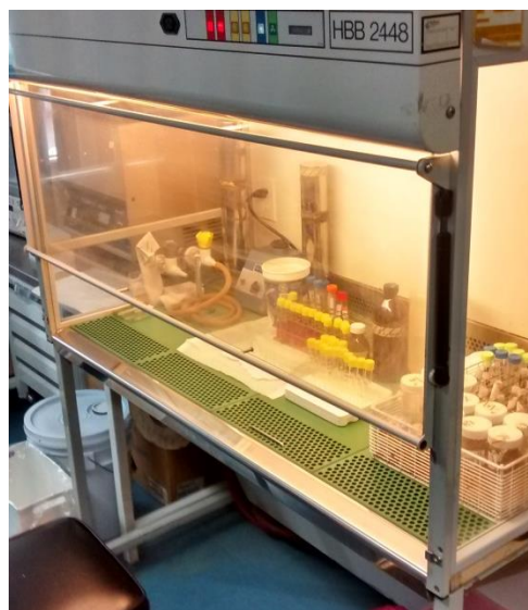
Figura 22. Campana de flujo laminar para la siembra de baciloscopias
