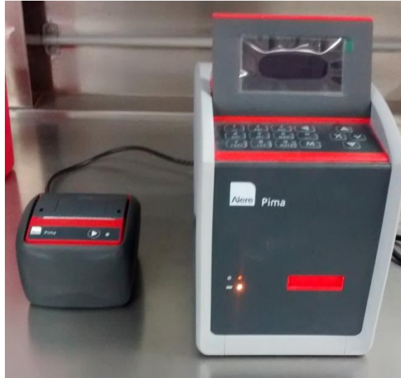
Figura 31. Equipo Alere Prima® utilizado en el área de Inmunología para el conteo de células CD4+
