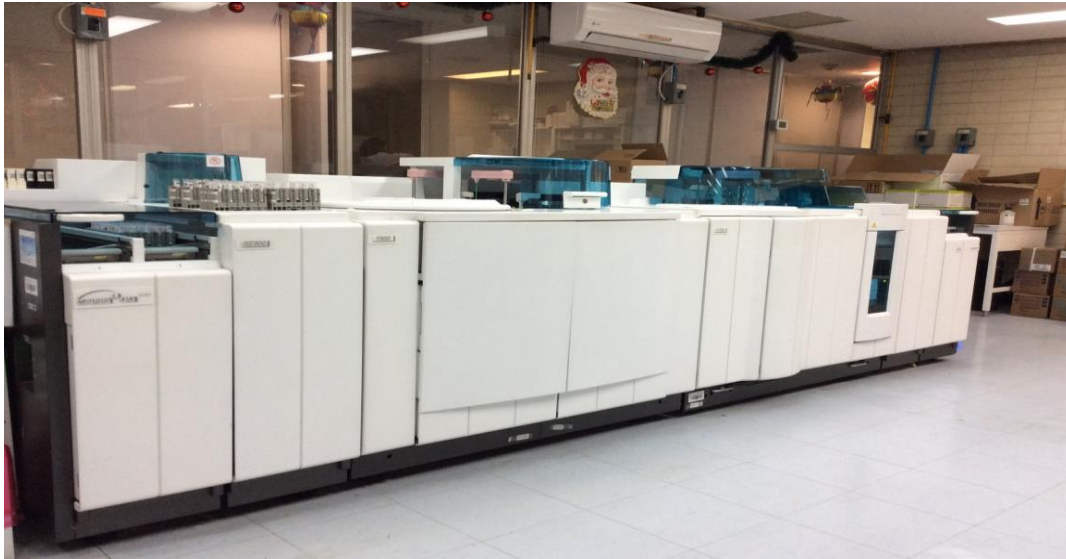
Figura 10. Equipo MODULAR EVO® utilizando en el área de inmunobioquímicas y hormonas
