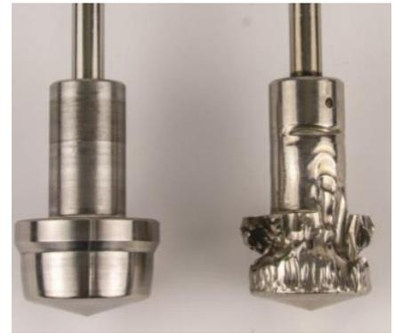
Fig. 19 Daños en los internos debidos a flashing
