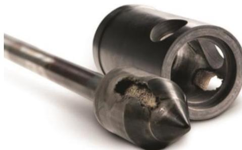
Fig. 158 Daños en los internos debido a cavitación
