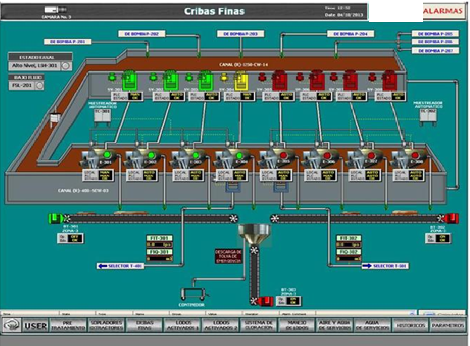
Figura 3-4b. Pretratamiento cribado fino en la PTAR Morelia, Atapameo
