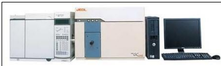
Figura 5.8 Espectrómetro de masas con cromatógrafo de gases acoplado (GC-MS).
