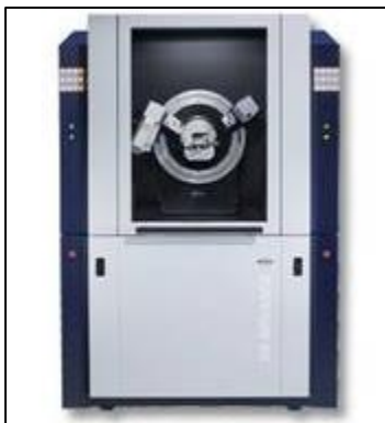
Figura 5.6 Difractómetro de rayos X (XRD).
