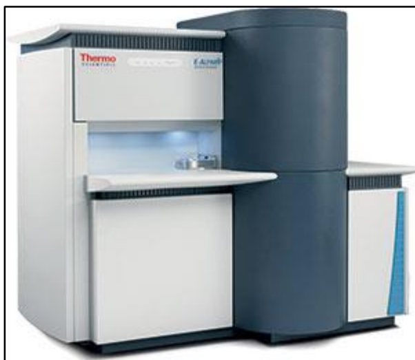
Figura 5.7 Espectrómetro de fotoelectrones de rayos X (XPS).
