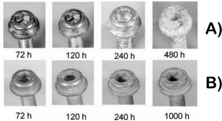
Figura 3.4. Comparación entre un recubrimiento de Zn puro A) y un recubrimiento Zn-Ni B) bajo un ensayo de niebla salina (Asociación de industrias de acabados de superficies, 2012)
