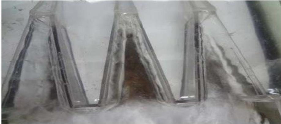
***Ilustración III.16 Interferencia de la descarga en el ápice aguas arriba.***
