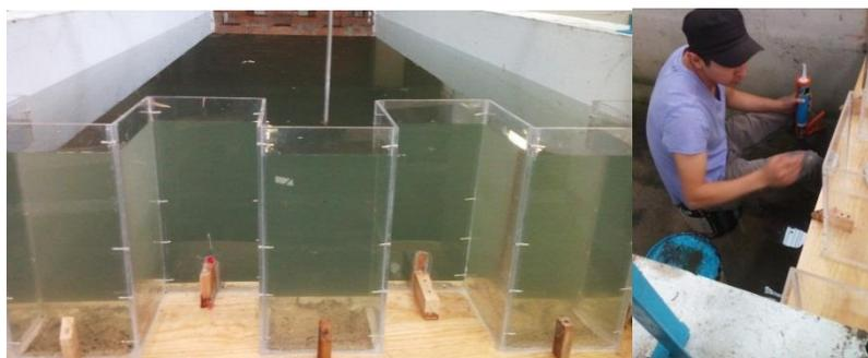
**Foto VI.8 Pruebas preliminares para localizar posibles fugas y sellarlas.**
