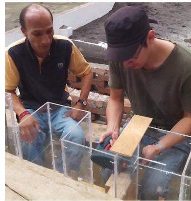
*Ajuste de la altura del vertedor.*
