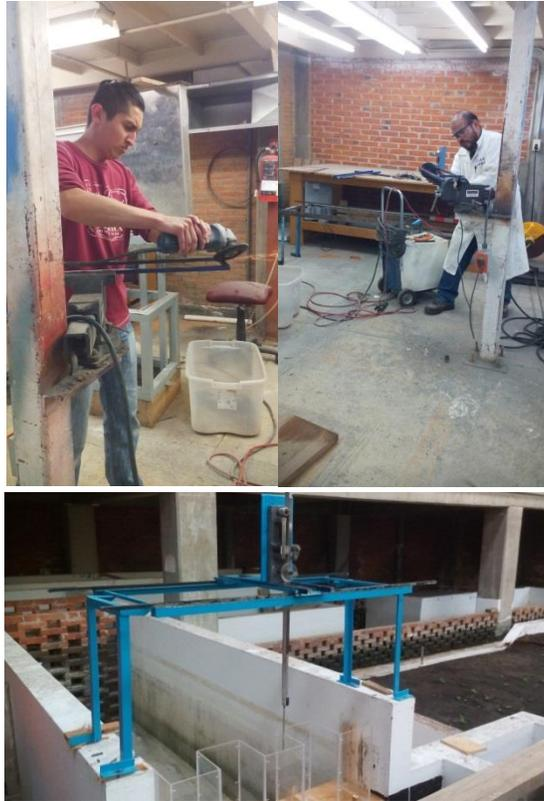
**Foto VI.9** Para poder determinar los tirantes se construyó un “puente” móvil en el cual se colocó el limnómetro para poder desplazarlo a todo lo largo de la longitud de la cresta.
