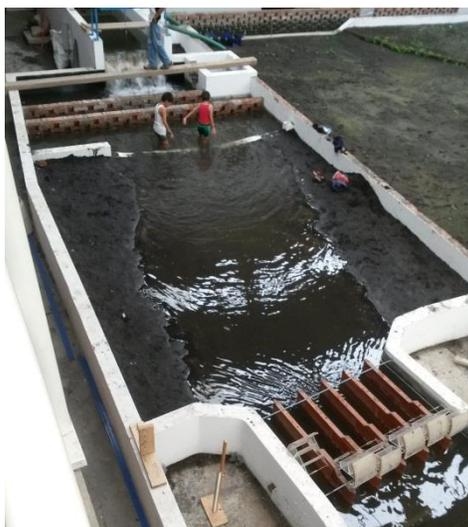
*Cauce del vertedor de laberinto ubicado en el laboratorio de hidráulica del IIUNAM.*
