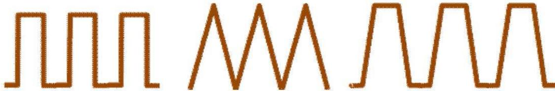
***Ilustración II. 14 Ejemplos de geometrías para un vertedor de laberinto rectangular, triangular, trapezoidal respectivamente.***
