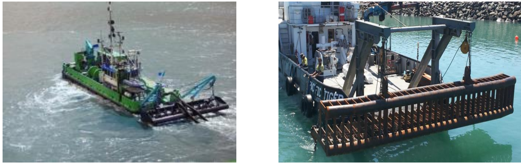
Ilustración 5-12, Rastra de fondo (Bed leveller) © 2014 DEME.
