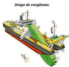
Ilustración 5-3, Draga de Cangilones (Sánchez, 2017)
