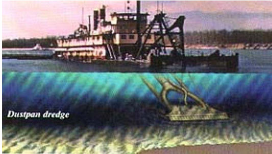
Ilustración 5-8, Draga Dustpan (© 2000-2017 GlobalSecurity.org).
