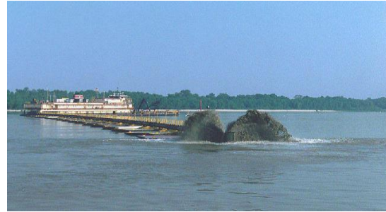
Ilustración 5-8, Draga Dustpan (© 2000-2017 GlobalSecurity.org).
