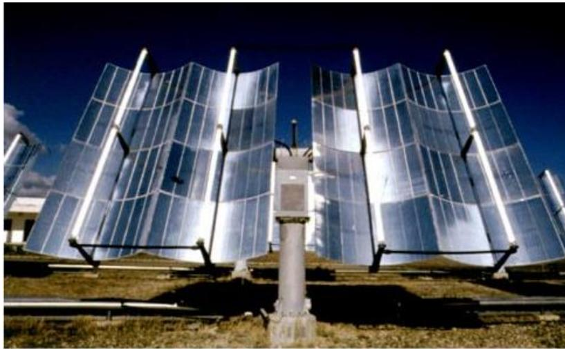
**Figura 1.13 Colector Cilindro Parabólico de dos ejes, Plataforma Solar de Almería, España (Estrucplan, 2015).**
