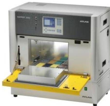
**Figura 2.3 Simulador solar Atlas SUNTEST+ utilizado en las pruebas en laboratorio**
