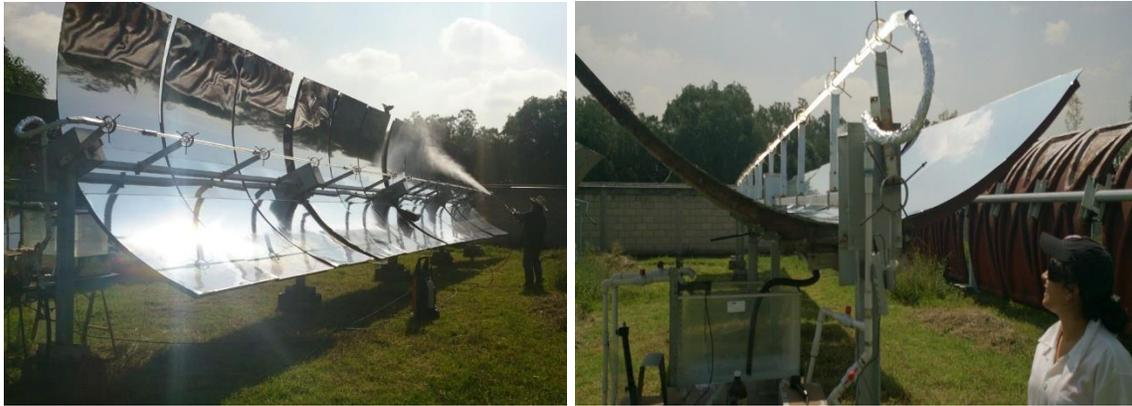
**Figura 2.6.- Reactor solar parabólico de la Planta Solar del Instituto de Ingeniería de la UNAM**
