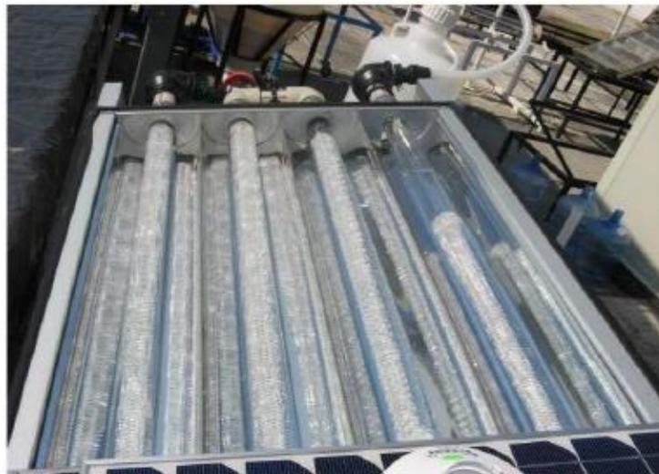
**Figura 1.11 Reactor solar CPC según Solis, 2013**
