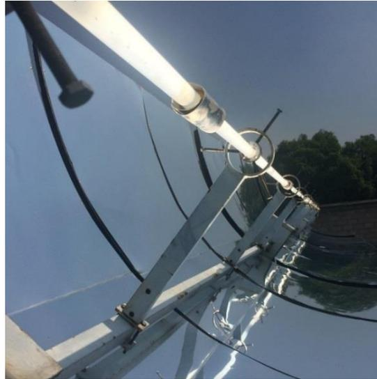
**Figura 2.8.- Tubos Pyrex® iluminados con la radiación concentrada.**
