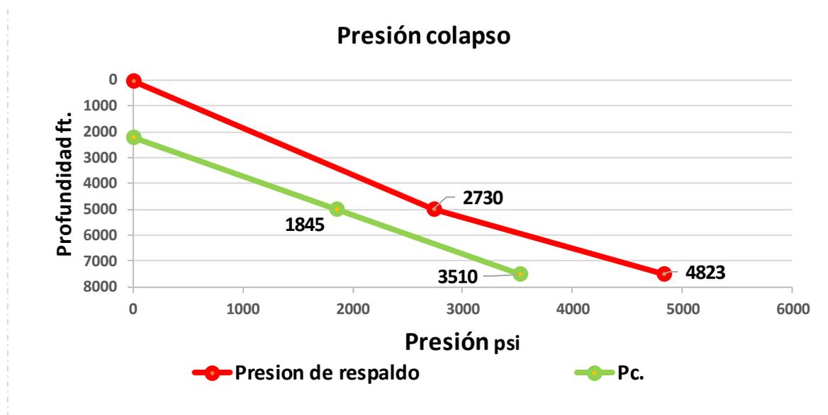
Resultante de la presión de colapso y la presión de respaldo.
