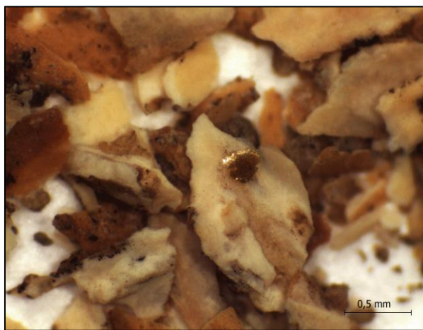
Figura 103: detalles de la muestra LV16-AV/E437 en la que se observan distintos fragmentos de mica. Fuente: elaboración propia, LANDIARH, UV.
