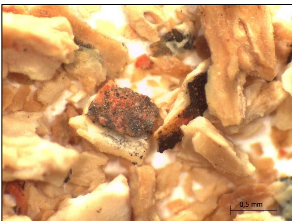
Figura 56: detalle de la muestra LV3-AVI/E73 en la que se observa una capa de pigmento negro. Fuente: elaboración propia, LANDIARH, UV.
