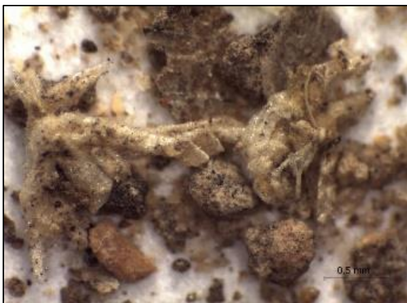
Figura 84: detalle de la muestra LV17-AIII/E422 donde se observa material de aspecto fibroso y nódulos blanquecinos y de matiz rosado. Fuente: elaboración propia, LANDIARH, UV.
