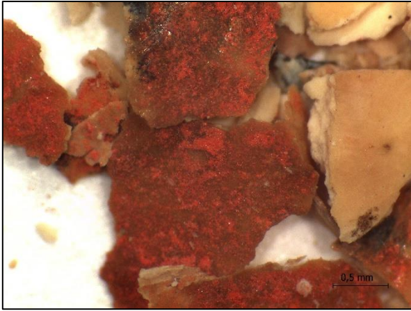
Figura 54: detalle de la muestra LV3-AIV/E73 en la que se observa la consistencia y la granulometría del pigmento rojo de tonalidad oscura. Fuente: elaboración propia, LANDIARH, UV.
