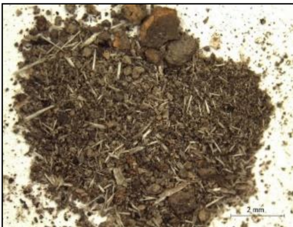
Figura 82: vista general de la muestra LV17-AI/E422 donde se observan las virutas de material blanco. Fuente: elaboración propia, LANDIARH, UV.
