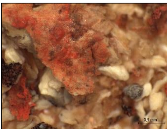
Figura 148: detalle del pigmento rojo de la muestra T1-AII/E67 que presenta granulometría muy fina y de matiz brillante. Fuente: elaboración propia, LANDIARH, UV.
