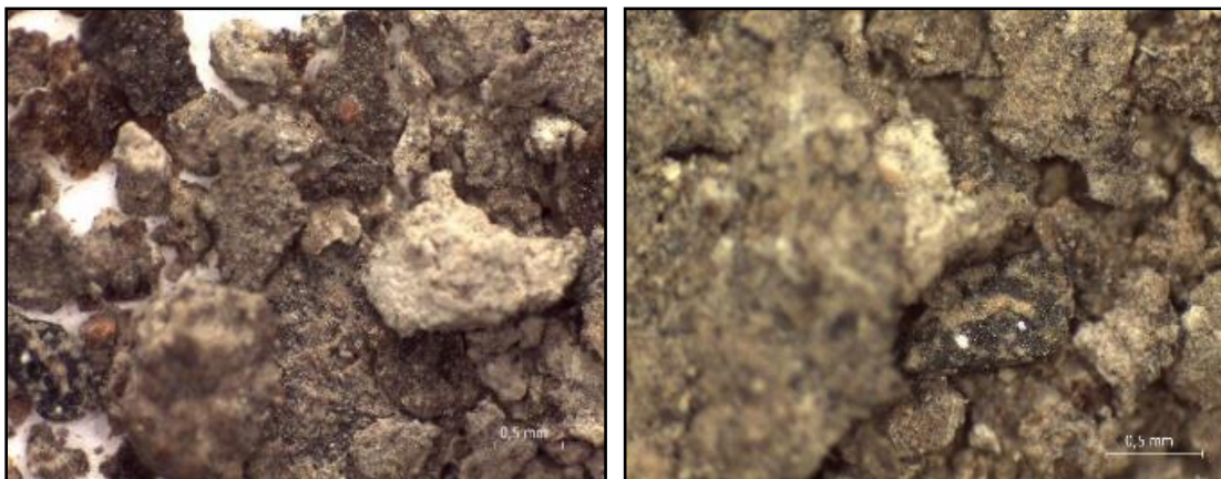
Figura 14: detalles de la muestra LV26-Al/E400 donde se observa los distintos materiales que pudieron conformarla, así como el pigmento negro con partículas brillantes de aspecto metálico. Fuente: elaboración propia, LANDIARH, UV.
