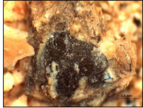
Figura 9: detalle de la muestra LV10-Al/E173b en la se observan las dos capas de color, posiblemente blanco sobre negro. Fuente: elaboración propia, LANDIARH, UV.
