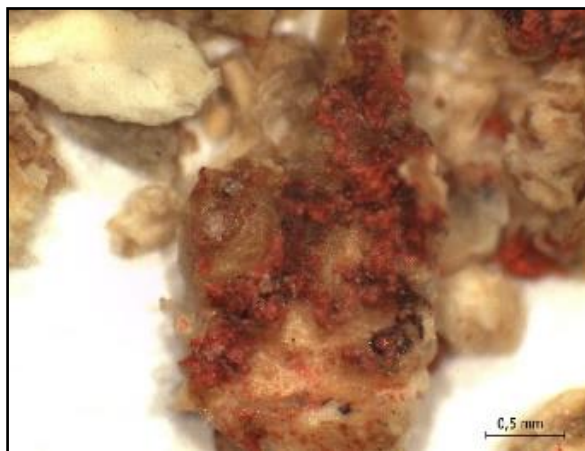
Figura 149: detalle del pigmento rojo de la muestra anterior (T1-AII/E67) que presenta una granulometría más gruesa. Fuente: elaboración propia, LANDIARH, UV.
