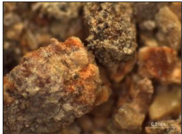
Figura 91: detalle de la muestra LV18-AII/E423 en la que se observa pigmento amarillo de matices anaranjados y aglomeraciones de color negro de textura arcillosa. Fuente: elaboración propia, LANDIARH, UV.
