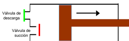
Figura 6.7. Compresor reciprocante de simple acción
