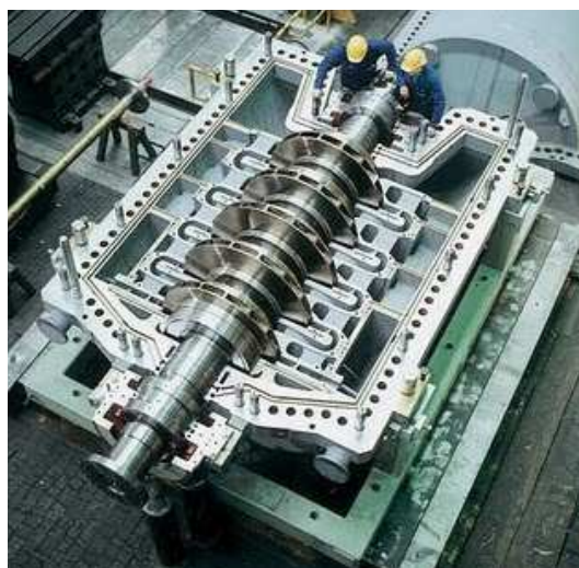
Figura 6.13. Compresor centrífugo multietapa
