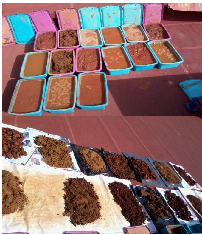
Figura 2b. Imágenes de los tratamientos-mezcla de jal encalado-suelo, jal-encalado con fosfatos (PO 4 )-suelo y jal-encalado con materia orgánica (MO)-suelo.
