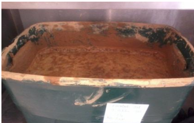
Figura 2a. Proceso de encalado del jal ácido con hidróxido de calcio \text{Ca}(\text{OH})_2
