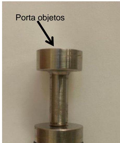
Ilustración 20. Pistón y porta objetos de la celda.
