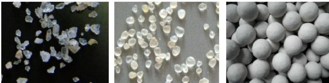
Figura 4.7 Arena, arena recubierta con resina y cerámicos, respectivamente. 86
