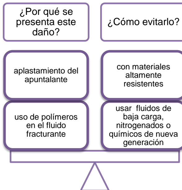
Figura 4.9 Reducción de la permeabilidad del agente sustentante.
