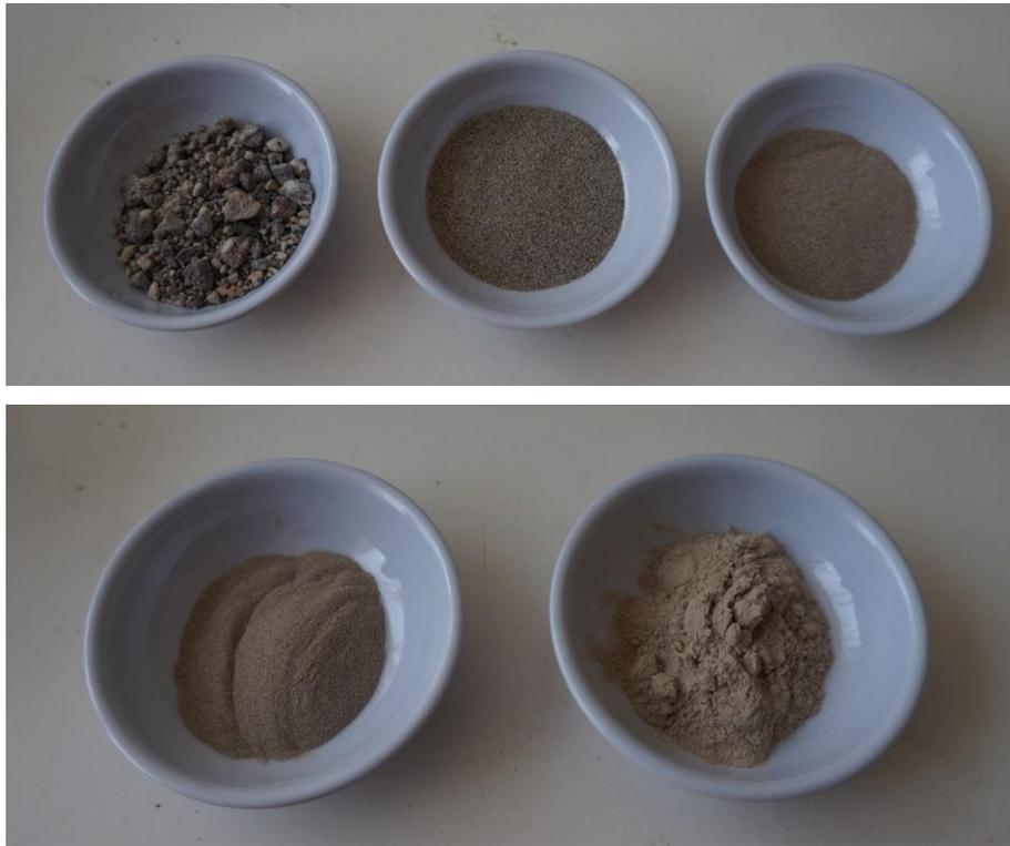
Figura 40. Material retenido por la malla: No.60 (sup. izq), No. 100 (sup. central), No.200 (sup. der.), No.325 (inf. izq.) y la menor de 325 (inf. der.). (Julio 2015)
