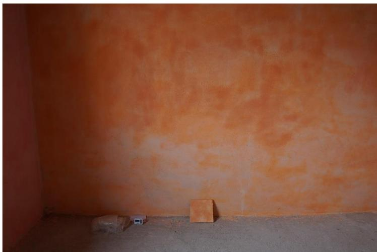
Figura 61. Probeta colocada junto al muro, en el cual fue aplicada la misma pintura. A la izquierda se encuentra el termómetro con higrómetro para monitorear la temperatura y humedad.
