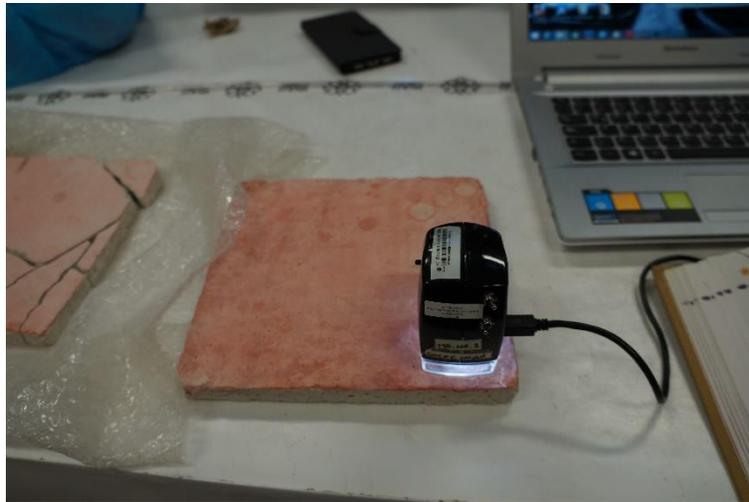
Figura 54. Microscopia óptica realizada con microscopio digital de mano con la cual se analiza una probeta posterior a las pruebas de permeabilidad.
