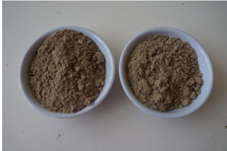
Figura 37. (Izq.) Arena sin tamizar, (Der.) Arena tamizada, utilizada para la elaboración de las tablillas.
