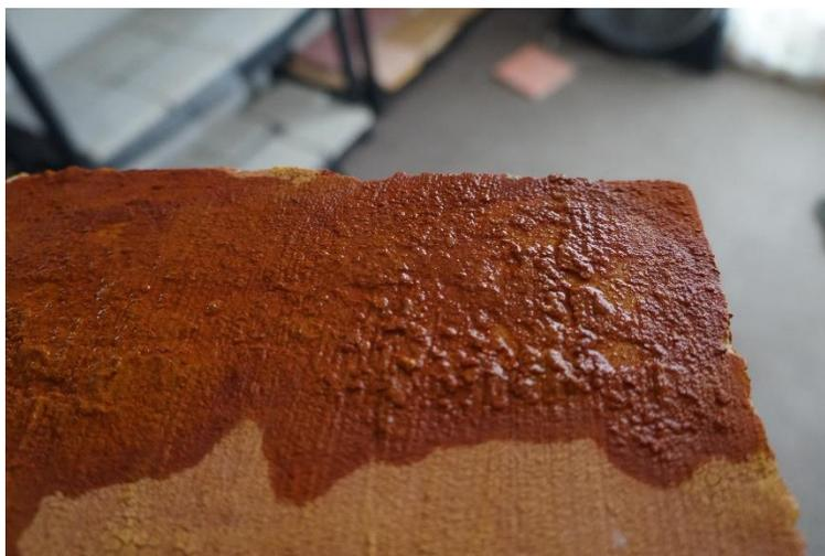
Figura 65. Saturación de la capa pictórica por acción del agua, en la probeta A-105
