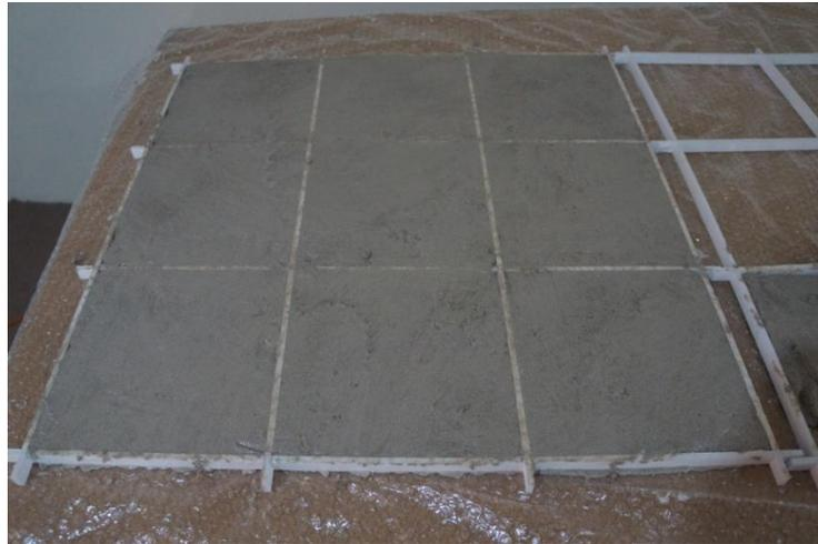
Figura 36. Molde de tablillas ya coladas con mortero cal-arena 1:3, cuenta con un plástico de las tablillas para un desmoldado más fácil y que reduzca las probabilidades de daño en las tablillas.
