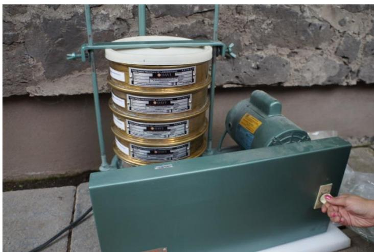
Figura 39. Criba mecánica, con las cribas No.60, No.100, No.200 y No.325 (en orden descendente).
