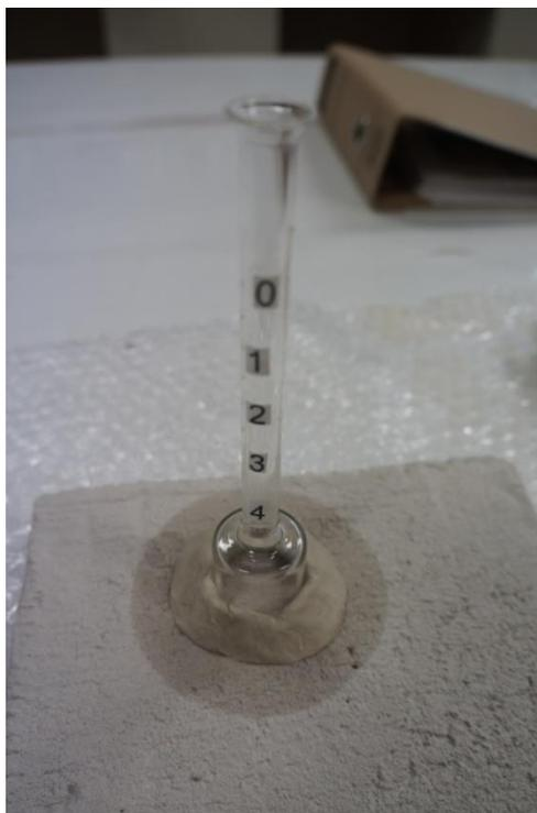
Figura 57. Prueba de permeabilidad terminada, en la parte inferior del tubo Karsten se observa el halo de agua absorbido en la prueba.
