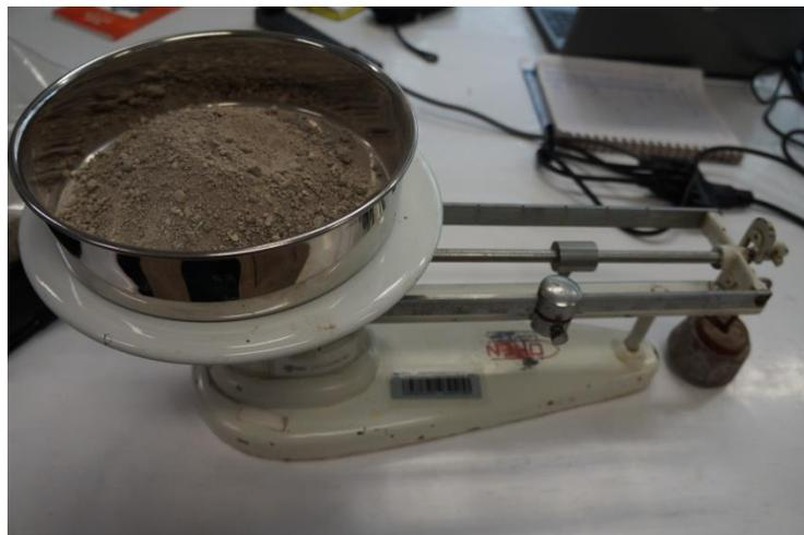
Figura 38. Báscula de precisión con la arena sin cribar, previo a la prueba de granulometría.
