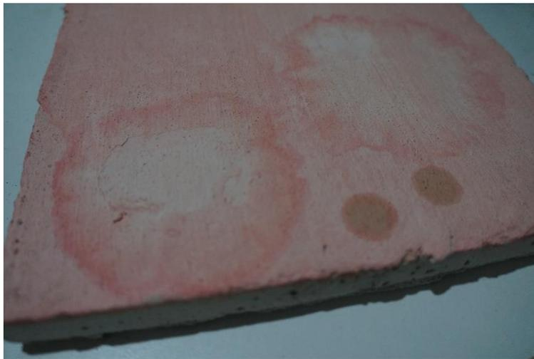
Figura 82. Superficie de la probeta B-103, después de realizadas las pruebas de permeabilidad con el tubo *Karsten* y a la gota.
