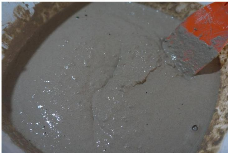
Figura 44. Mezcla para el enlucido fino, contiene arena tamizada con malla No.325, cal hidráulica y mucílago de nopal, previo a su colocación en la tablilla.
