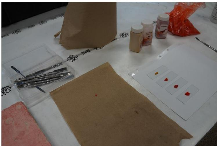
Figura 55. Pigmentos de cúrcuma, dos tipos de pimentón y paprika sobre portaobjetos (der.), previos a la incorporación de aceite mineral y acetona, para su análisis microscópico.
